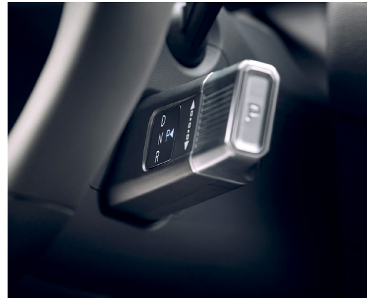
Підкермовий селектор перемикання передач (SBW)
